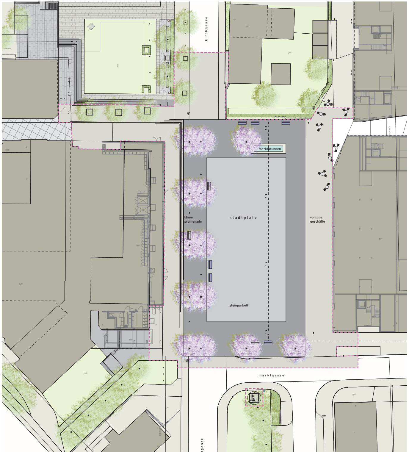
Abbildung 6: Situationsplan des Stadtplatzes: Marktbrunnen vor dem Bauernhaus Kirchgasse 12 (oben), Toilettenanlage an der Markt-gasse (unten). Dank dem Standort ausserhalb der offenen Platzfläche ist das Toilettegebäude bei Veranstaltungen nicht im Weg und dennoch gut erreichbar. Bei grossen Veranstaltungen kann es mit einem temporären WC-Wagen ergänzt werden.
